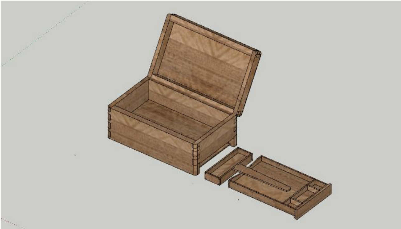
Coffret ouvert présentant les deux sous-ensembles correspondant aux compartiments secrets, mettant en évidence l'organisation interne de l'ouvrage.
